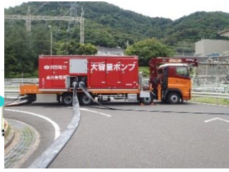
大容量ポンプ
