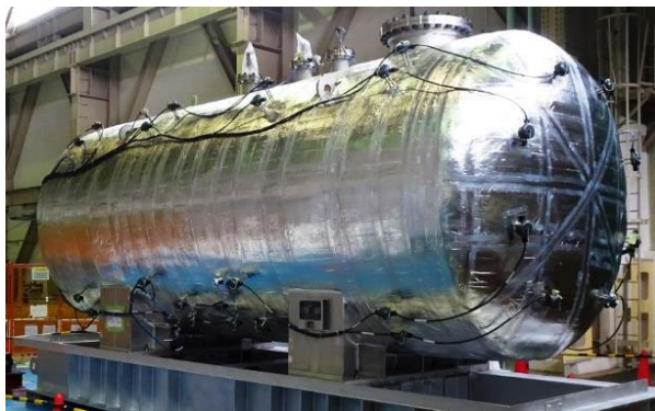
2次系ナトリウム 一時保管用タンク (8月10日時点)
