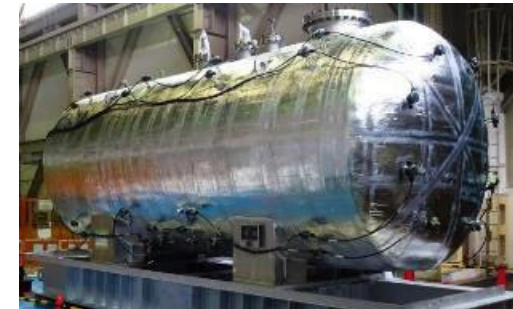
もんじゅ2次冷却材ナトリウム 一時保管用タンク
