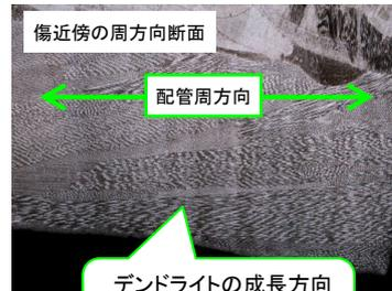
デンドライトの成長方向が配管周方向に成長しているように観察される。
