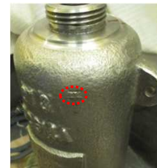
打痕を確認 (長さ9mm、幅1mm)
