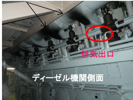
ディーゼル機関側面 インジケータコック排気出口周辺
