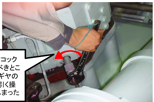
インジケータコック開操作写真
