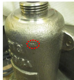
打痕を確認 (長さ9mm、幅1mm)
