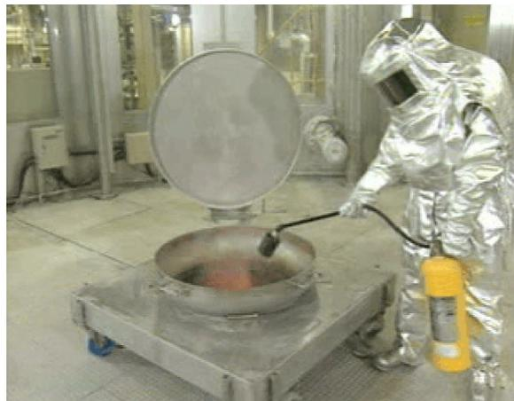
図1-5-6 ナトリウム取扱コース (ナトリウム消火訓練)
