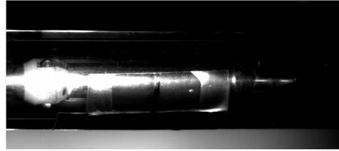
高速度カメラによるプローブ振動の観察
