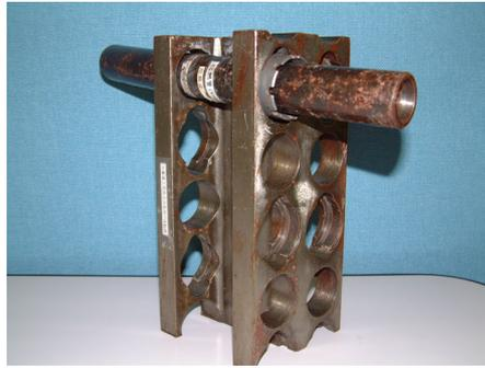
伝熱管は支持構造に固定されており、振れを防止している。
