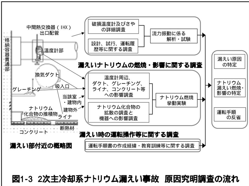
図1-3 2次主冷却系ナトリウム漏えい事故 原因究明調査の流れ
