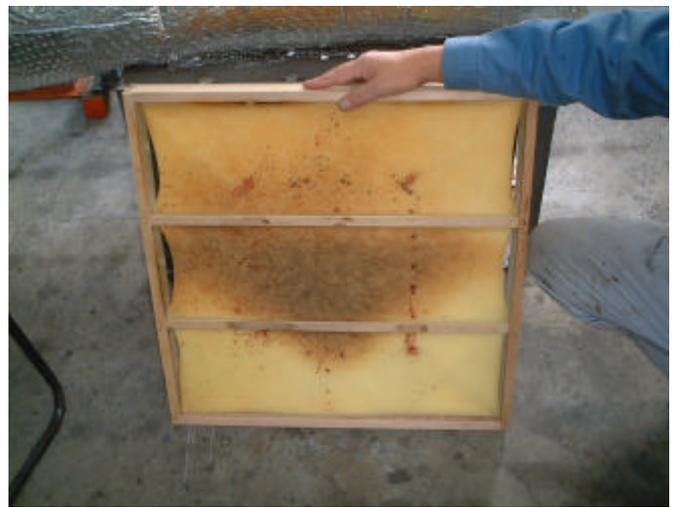
フィルタ燃焼試験後 プレフィルタ外観写真
