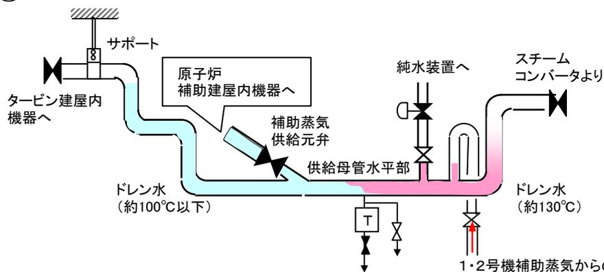
閉止した補助蒸気供給元弁の上流側で配管表面からの放熱により蒸気がドレン水になり滞留し、水平配管部が満水となった。
