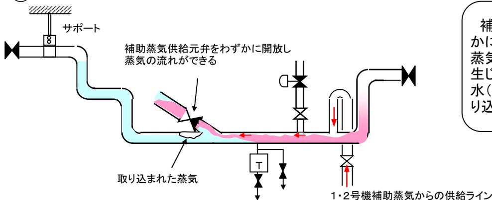
補助蒸気供給元弁を僅かに開放したことにより、蒸気(約170°C)の流れが生じ一部の蒸気がドレン水(約100°C以下)中に取り込まれた。
