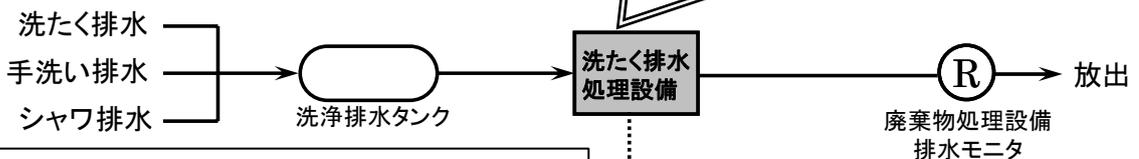
洗たく排水処理設備は、管理区域内で使用した作業服等の洗たくにより発生する排水(手洗排水及びシャワ排水を含む)を処理する設備である。
