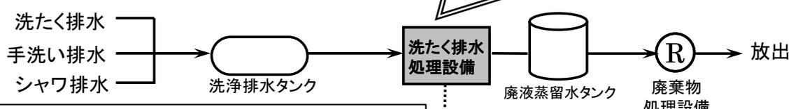
洗たく排水処理設備は、管理区域内で使用した作業服等の洗たくにより発生する排水(手洗排水及びシャワ排水を含む)を処理する設備である。
