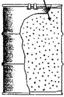
原子力発電所の定期検査時等の工事に伴い発生した濃縮廃液等の低レベル放射性廃棄物をセメント、アスファルト等を用いて均質(均一)にしてドラム缶に収納して固型化したもの。
