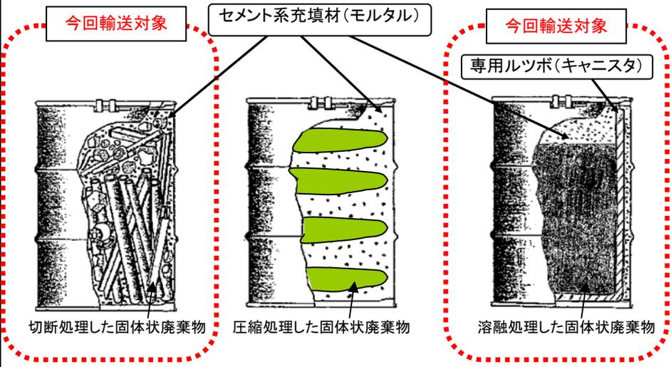
原子力発電所の定期検査時等の工事に伴い発生した、金属類、プラスチック、フィルタ類などの固体状の低レベル放射性廃棄物を種類毎に分別後、切断、圧縮または溶融処理してドラム缶に収納して、セメント系充填材(モルタル)で固型化したもの。
