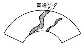
腐食が進行し、傷に沿った部分に漏えい経路を形成、蒸気が漏えい
