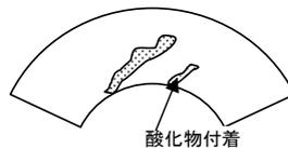
フランジ・パッキン間の傷の部分に、運転中は蒸気が浸入し、また停止中は酸素の供給により腐食が進行
