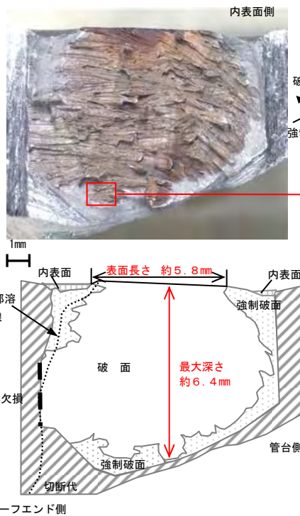
No. 3 割れの破面観察結果
