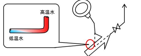
配管ルートを変更することにより、高温水と低温水の境界を曲がり部から外し、熱疲労割れの懸念を解消する。
