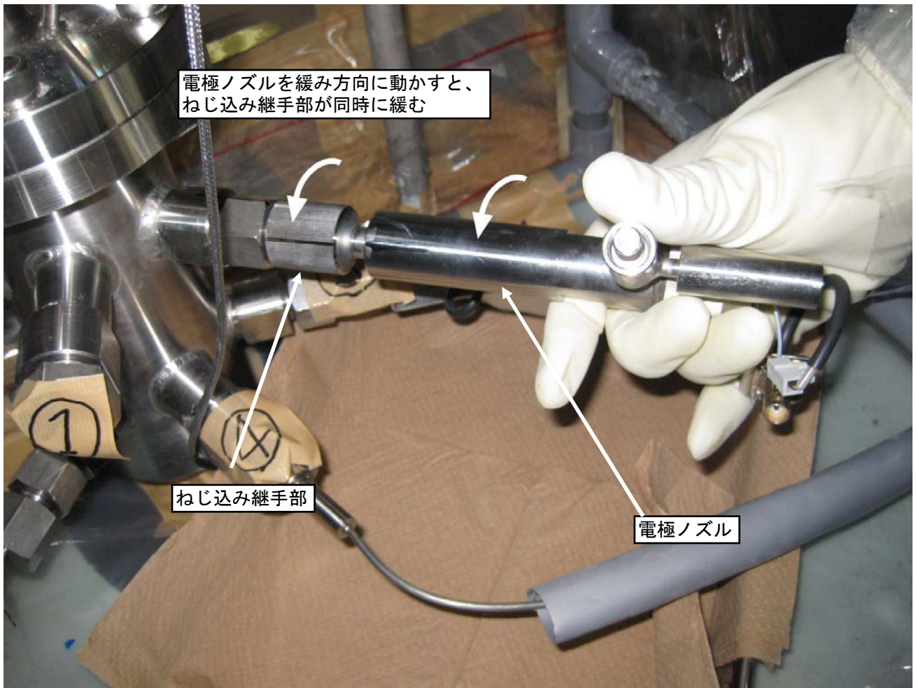
電極ノズルとねじ込み継手部との連動性の状況
