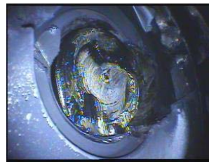
<過給機付近にて発見された金属片>
