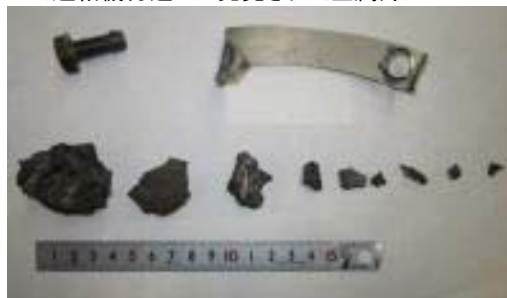
<過給機付近にて発見された金属片>
