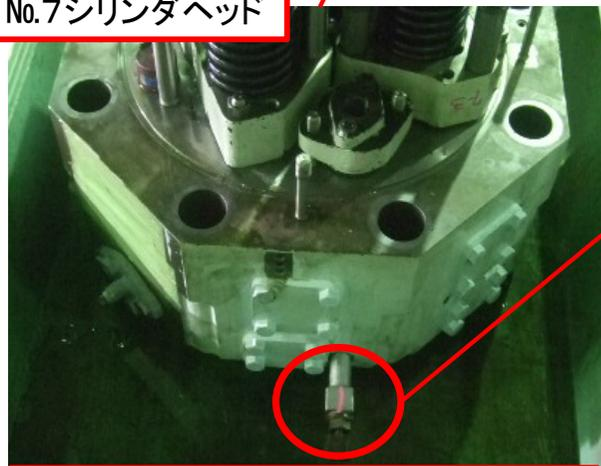
工場において浸透探傷試験や作動試験等によって詳細に確認した結果、異常がないことから再使用
