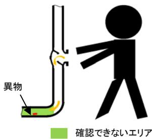
作業時に使用する機材や作業員の衣服等に付着した異物が垂直方向の配管内に落ちると、作業後の異物確認時に目視が困難な範囲がある
