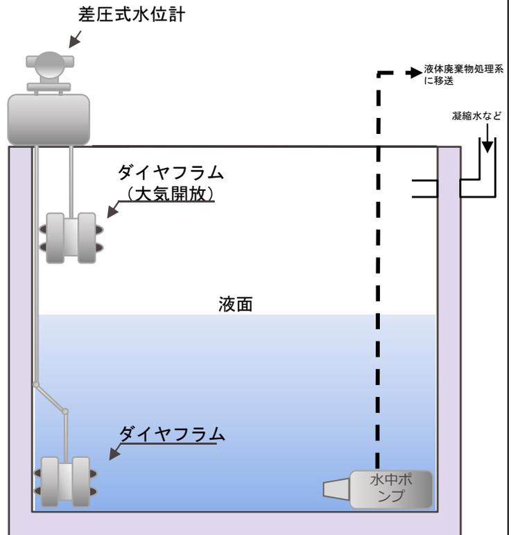
格納容器サンプル：格納容器内の凝縮水などの床ドレンが溜まる。通常運転中の水位は50%から85%であり、水位が85%になれば水中ポンプで液体廃棄物処理系へ移送する。
