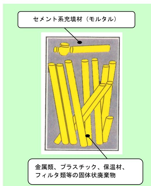
保温材・フィルタ類等を圧縮し、セメント系充填材（モルタル）で一体となるよう固型化したもの
