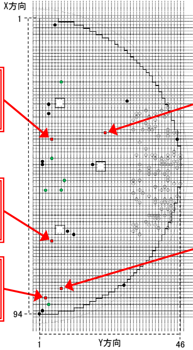
C-蒸気発生器上部から見た 伝熱管位置を示す図
