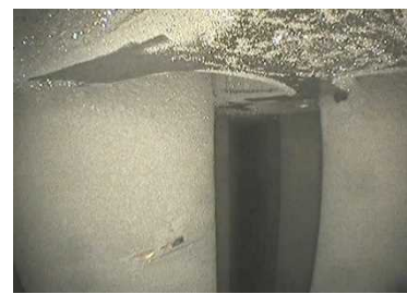
(C-SG第6管支持板のきずの状況)
