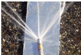
第3～6管支持板用(噴射ノズルを改良)
