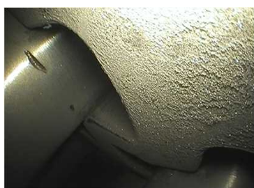
(C-SG第3管支持板のきずの状況)
