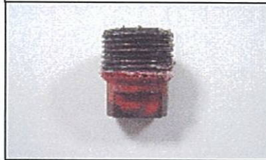
加熱蒸気室ドレン抜き栓の写真
