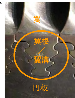
【軸と円板を一体成型したロータ】
