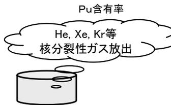
Puスポット※1により核分裂生成ガス(以下、FPガス)放出が若干多くなる。
