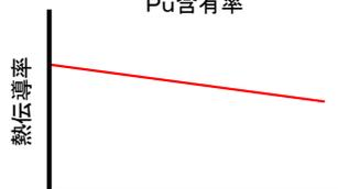
Puの含有量が大きくなると、ペレットの熱伝導率が低下する。
