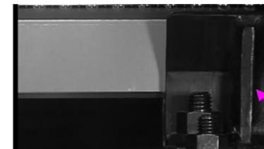
燃料集合体をのせる検査架台の台座
