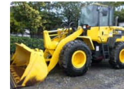
消防車等が瓦礫により走行できない時を考慮し、ホイールローダーを配備
