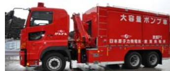
消防用大容量ポンプ車: 通常は高台に保管
