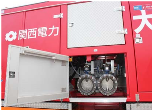
写真 2-1 大容量ポンプ接続口
