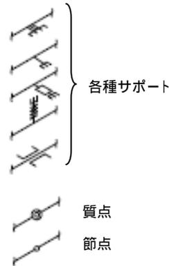
建屋応答地震動を各サポート点から配管系に入力
