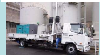
仮設中圧ポンプ
