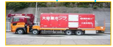
大容量ポンプの配備
