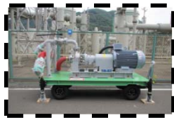
可搬式代替低圧注水ポンプ (写真は高浜3,4号機)
