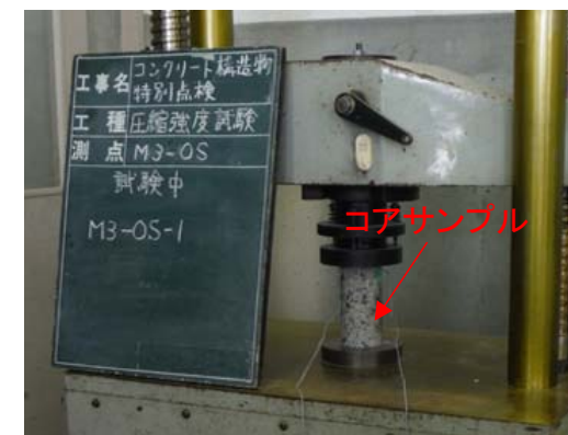
強度の点検事例 (耐圧試験機による確認)
