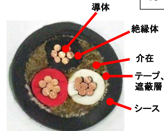
代表的なケーブルの構造
