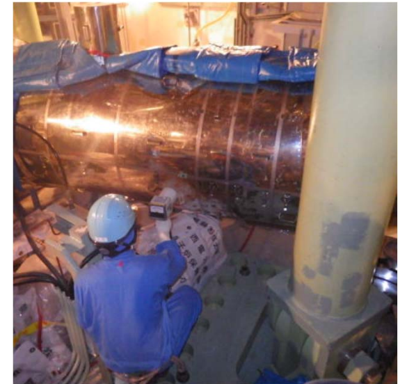
機器・配管の表面線量率を測定
