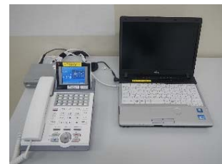
緊急時衛星通報システム
