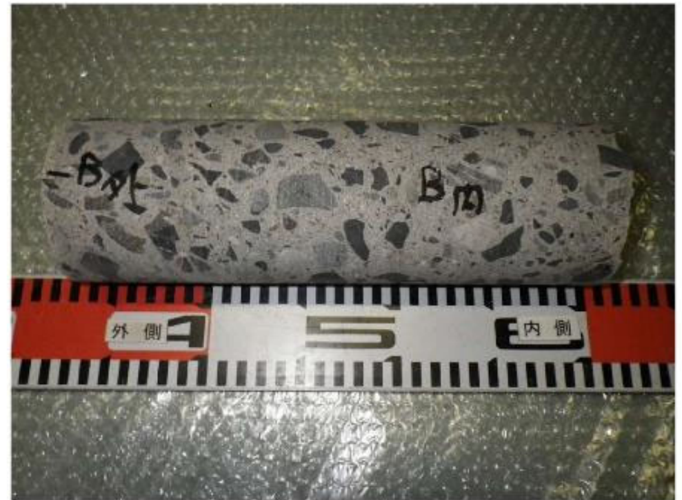
コンクリートコアサンプルの例
